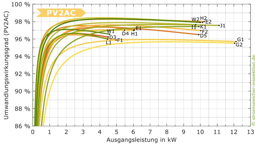
**Bild 36** Wirkungsgradkennlinien der PV-Einspeisung (PV2AC) der DC-gekoppelten Systeme sowie der PV-Wechselrichter W1 und W2.
