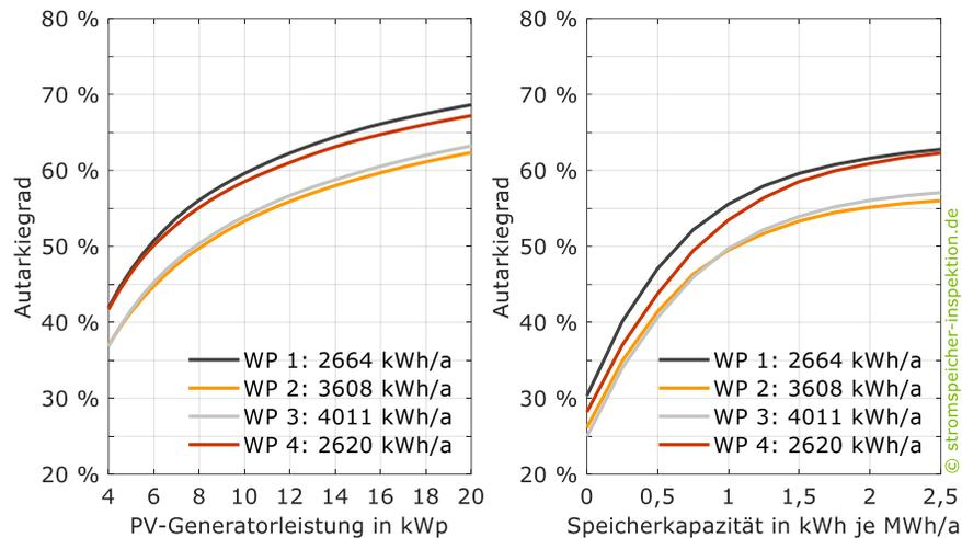
**Bild 34** Autarkiegrad des Referenzhaushalts in Verbindung mit 4 Wärmepumpen (WP) in Abhängigkeit von der PV-Generatorleistung bei einer nutzbaren Speicherkapazität von 1,5 kWh je 1000 kWh/a (1 MWh/a) (links) sowie in Abhängigkeit der spezifischen nutzbaren Speicherkapazität bei einer PV-Generatorleistung von 10 kWp (rechts).
