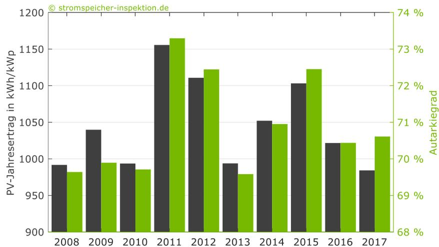
**Bild 29** Variation des PV-Jahresertrags und des Autarkiegrads für das am Standort Lindenberg (Brandenburg) simulierte Referenzsystem (Wetterdaten: DWD).
