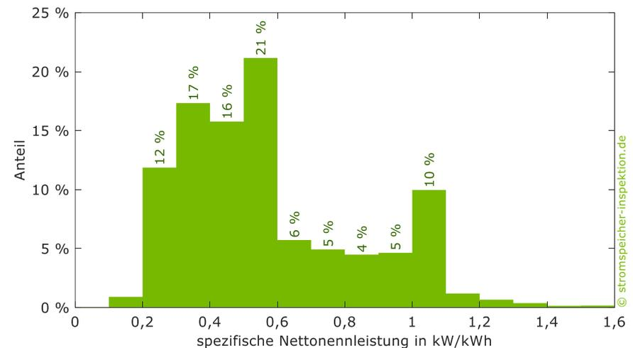
**Bild 5** Häufigkeitsverteilung der Nennleistung im Verhältnis zur nutzbaren Speicherkapazität der im Jahr 2020 installierten Speichersysteme kleiner als 20 kWh und 20 kW (Anzahl der Systeme: 82.479, Daten: Marktstammdatenregister).
