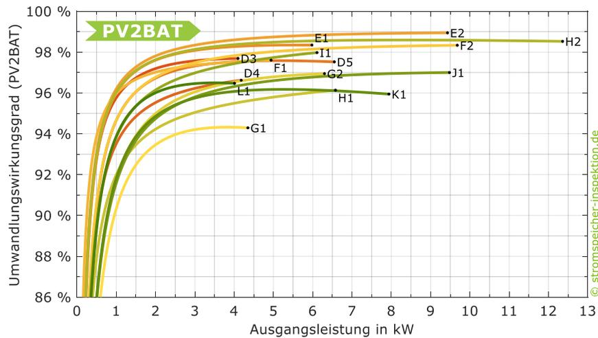
**Bild 37** Wirkungsgradkennlinien der PV-Batterieladung (PV2BAT) der DC-gekoppelten Systeme.
