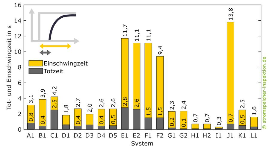
**Bild 15** Mittlere Tot- und Einschwingzeiten der untersuchten Systeme.
