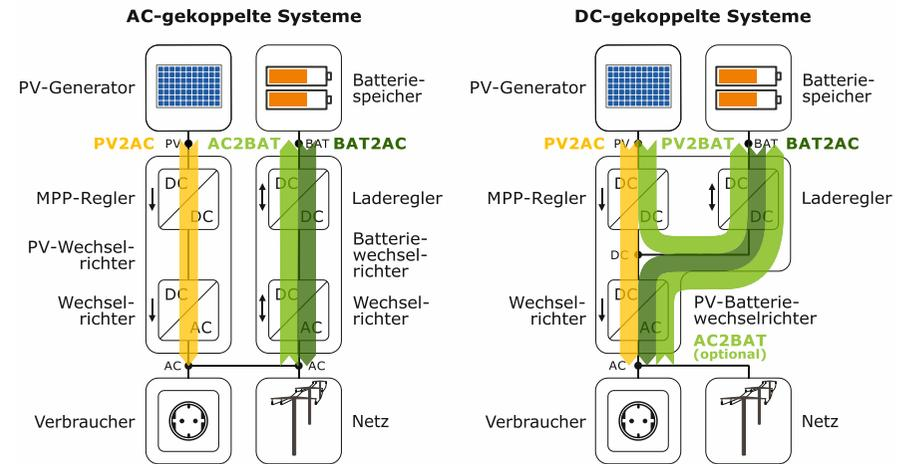
**Bild 12** Komponenten und Energieumwandlungspfade von AC-gekoppelten (links) und DC-gekoppelten PV-Speichersystemen (rechts).
