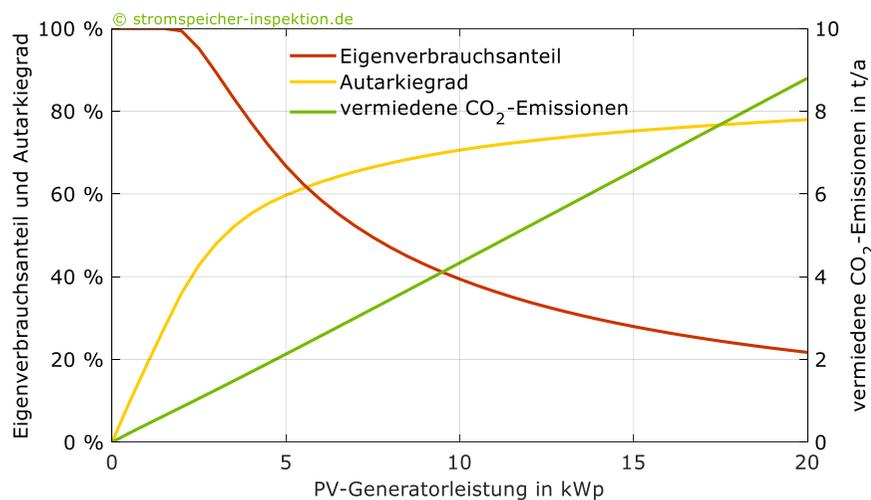
**Bild 35** Einfluss der Größe der PV-Anlage auf den Autarkiegrad und Eigenverbrauchsanteil sowie auf die vermiedenen CO<sub>2</sub>-Emissionen (Stromverbrauch 5010 kWh/a, nutzbare Speicherkapazität 7,5 kWh).
