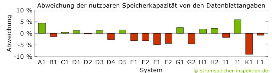
**Bild 9** Differenz zwischen den Labormesswerten und Datenblattangaben der nutzbaren Speicherkapazität (positive Abweichung: Messwert größer als Datenblattwert, negative Abweichung: Messwert kleiner als Datenblattwert).
