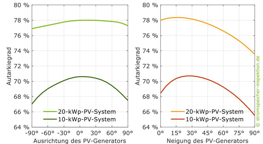
**Bild 30** Einfluss der Ausrichtung zwischen Ost (-90°) und West (90°) (links) und der Neigung (rechts) der PV-Anlage auf den Autarkiegrad bei unterschiedlichen PV-Generatorleistungen (nutzbare Speicherkapazität 7,5 kWh, links: Neigung 35°, rechts: Süd-Ausrichtung (0°)).
