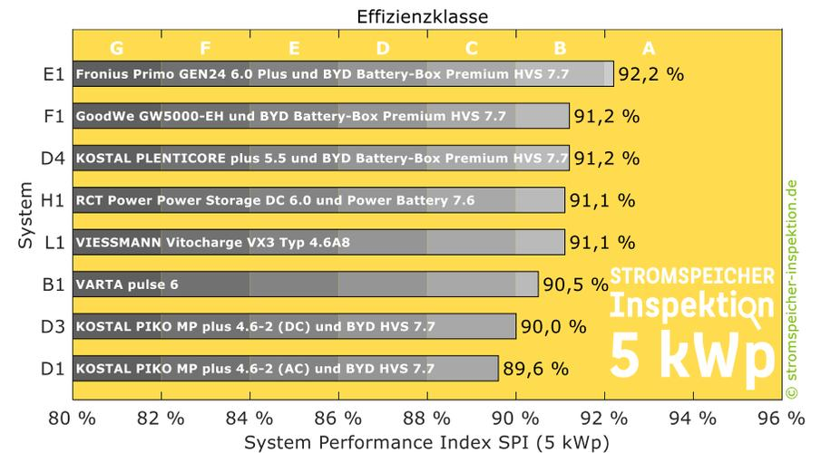
**Bild 21** SPI (5 kWp) und Effizienzklassen der untersuchten PV-Speichersysteme.
