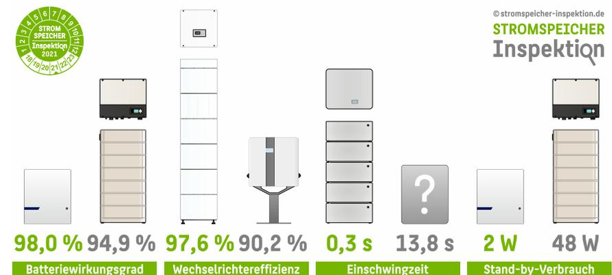
**Bild 19** Bandbreite der wichtigsten Effizienzeigenschaften (Wechselrichtereffizienz: mittlerer Umwandlungswirkungsgrad im Entladebetrieb, Stand-by-Verbrauch: Stand-by-Leistungsaufnahme bei entladem Batteriespeicher).
