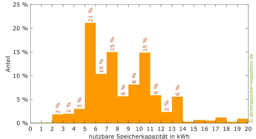
**Bild 4** Häufigkeitsverteilung der nutzbaren Speicherkapazität der im Jahr 2020 installierten Speichersysteme mit einer nutzbaren Speicherkapazität kleiner als 20 kWh und einer Nettonennleistung kleiner als 20 kW (Anzahl der Systeme: 82.479, Daten: Marktstammdatenregister).
