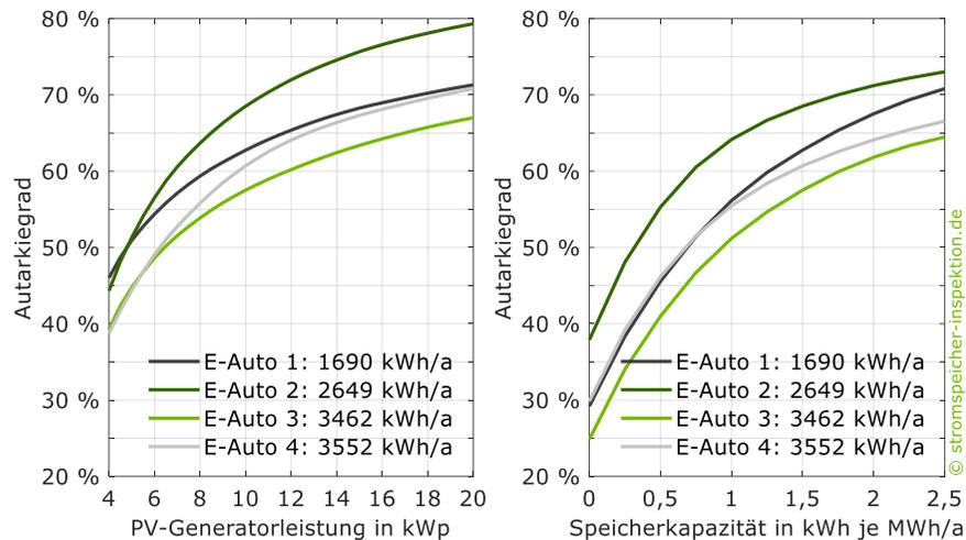
**Bild 33** Autarkiegrad des Referenzhaushalts in Verbindung mit 4 Elektroautos (E-Autos) in Abhängigkeit von der PV-Generatorleistung bei einer nutzbaren Speicherkapazität von 1,5 kWh je 1000 kWh/a (1 MWh/a) (links) sowie in Abhängigkeit von der nutzbaren Speicherkapazität bei einer PV-Generatorleistung von 10 kWp (rechts).
