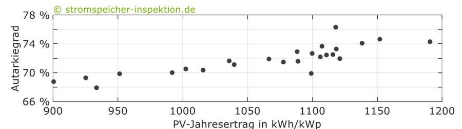
**Bild 28** Variation des Autarkiegrads in Abhängigkeit vom PV-Jahresertrag für 25 Standorte in Deutschland (Wetterdaten: DWD 2012).
