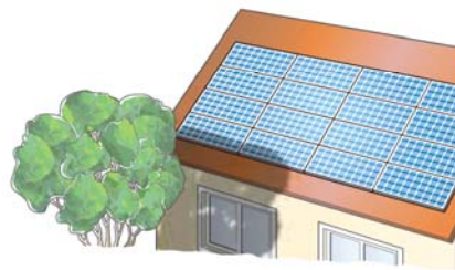
Schattenwurf auf 2 Module Insgesamt betroffen sind 2 Bypassdioden
