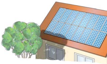
Schattenwurf auf 4 Module Insgesamt betroffen sind 7 Bypassdioden
